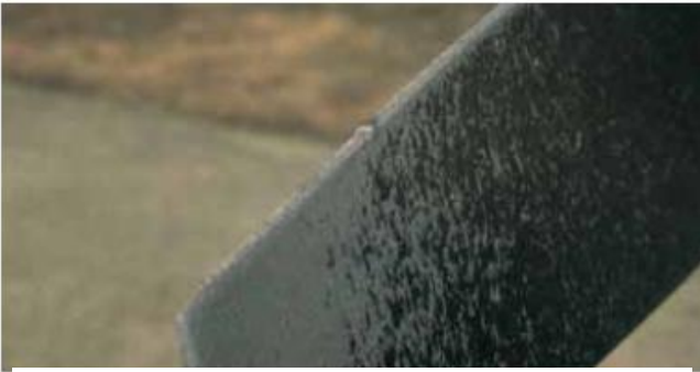
שחיקת להב: מתכת חשופה משותכת במהירות. שמירת להבים צבועים כיאות אינה תחזוקה שגרתית יקרה
