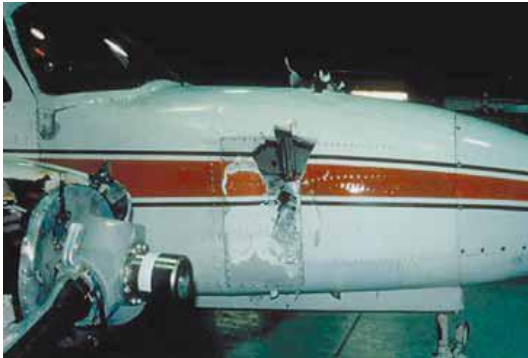
כישלון טבור קטסטרופלי שגרם להינתקות להבים וחדירה לחרטום
